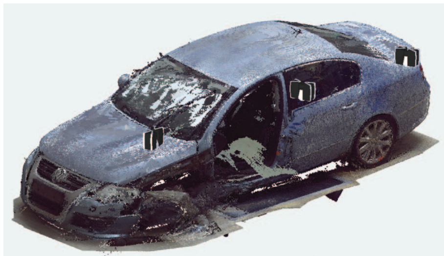
Výsledný naskenovaný model havarovaného vozidla.
