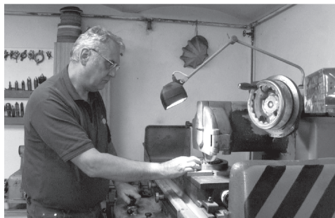
Zhotovitel při broušení krokového kola na brusce na plocho.
