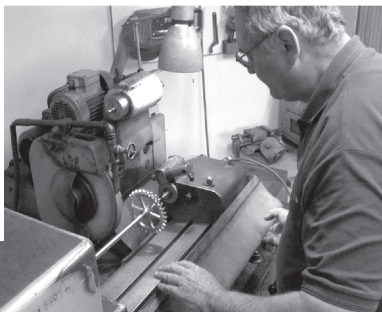
Broušení obvodu krokového kola na brusce na kulato BUA 20.
