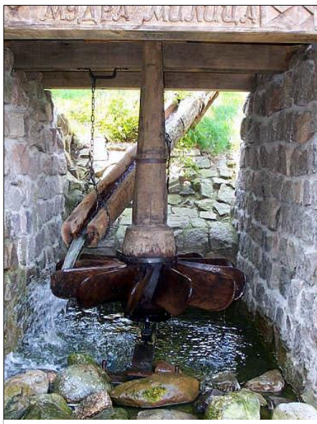
Vodní kolo řeckého typu, užívané na Balkáně, zvané vodenica
