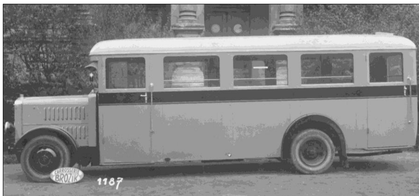
Autobus p. Alberta Šustka. Karoserii ze dřeva potaženou koženkou udělal jeho otec František Šustek.
